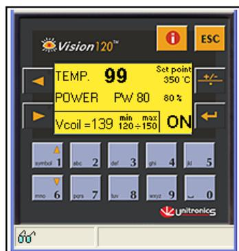
L'armadio contiene tutti i componenti elettrici, il generatore di potenza, il refrigeratore e il **pannello comandi**, dotato di un PLC con display per l'impostazione e la visualizzazione dei parametri di lavoro.
