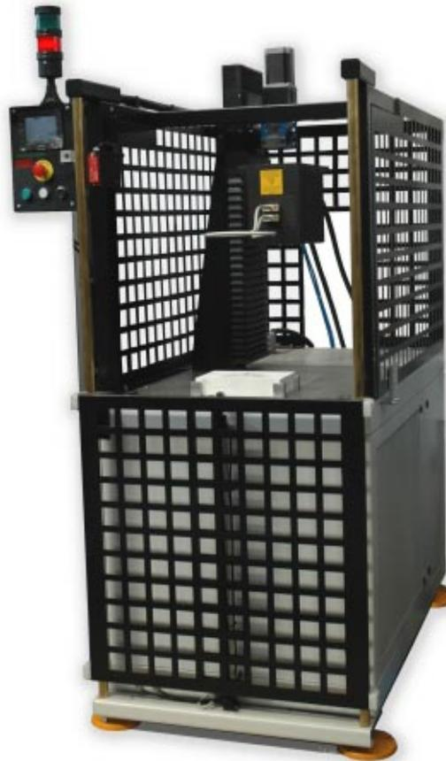
Ogni impianto è assemblato su una **struttura** metallica portante in acciaio sulla quale sono alloggiati sia l'armadio elettrico che il piano di lavoro dotato di adeguate recinzioni metalliche.
